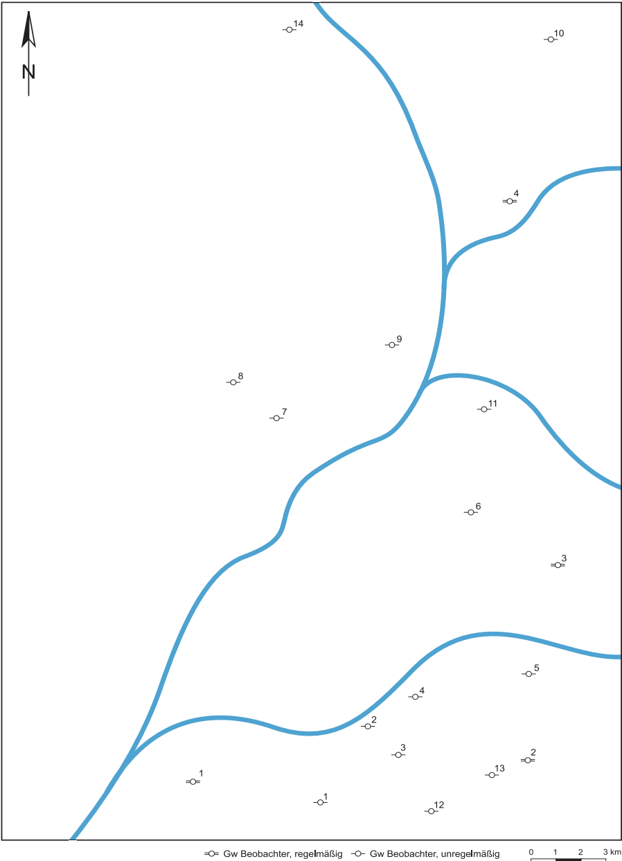
Abb. 5.1: Schematisches Beispiel eines Plans der vorhandenen Grundwassermessstellen.
